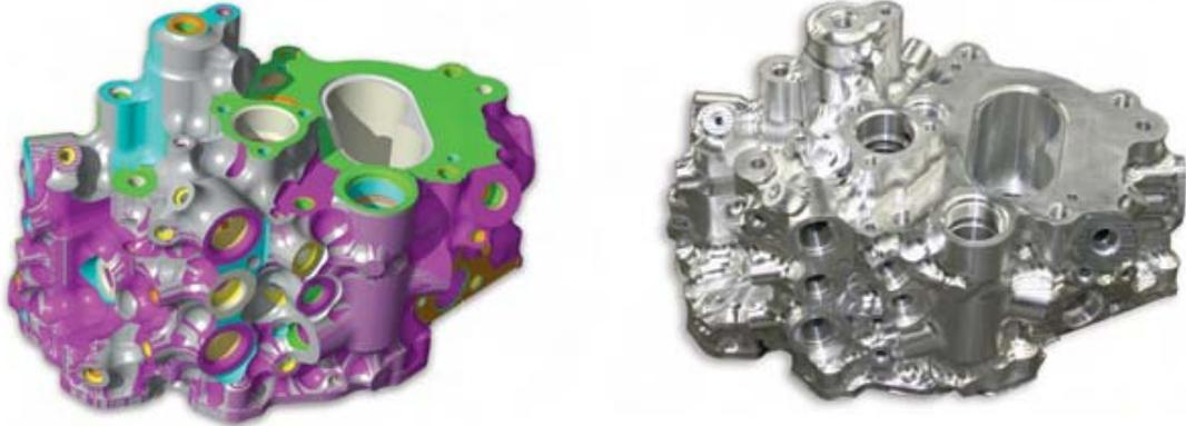
**設計モデルをベリカットの「加工されたままの」モデルと比較し、Tell Tool は削り込みの位置を確認できる**
